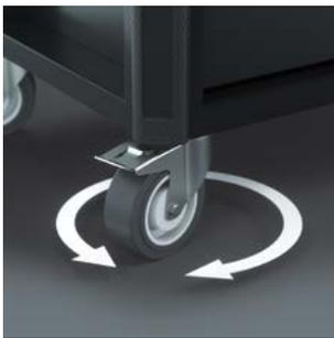
Die 2 Lenkrollen sind mit Doppelstopp ausgestattet: Die gebremste Rolle verhindert zuverlässig das Wegrollen, das gebremste Schwenklager verhindert das ungewollte Drehen der Lenkrollen, z. B. auf schrägen Flächen. Die öl- und säurebeständigen Elastikrollen sorgen für einen ruhigen Lauf. Ein Schutzring vermeidet das Eindringen von Schmutz und Fäden.
